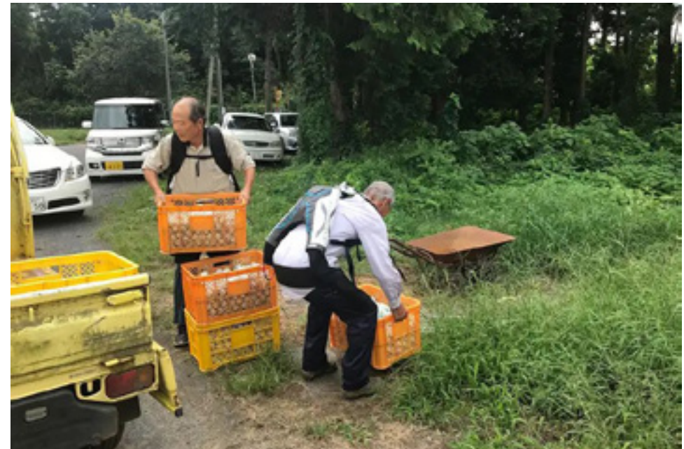
Abb 12: Ältere japanische Arbeiter mit Exoskelett, Courtesy of Daigo Orihara
