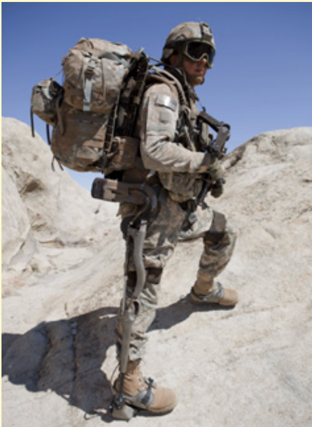
Abb 9: HULC (Human Universal Load Carrier) hydraulisches Exoskelett
